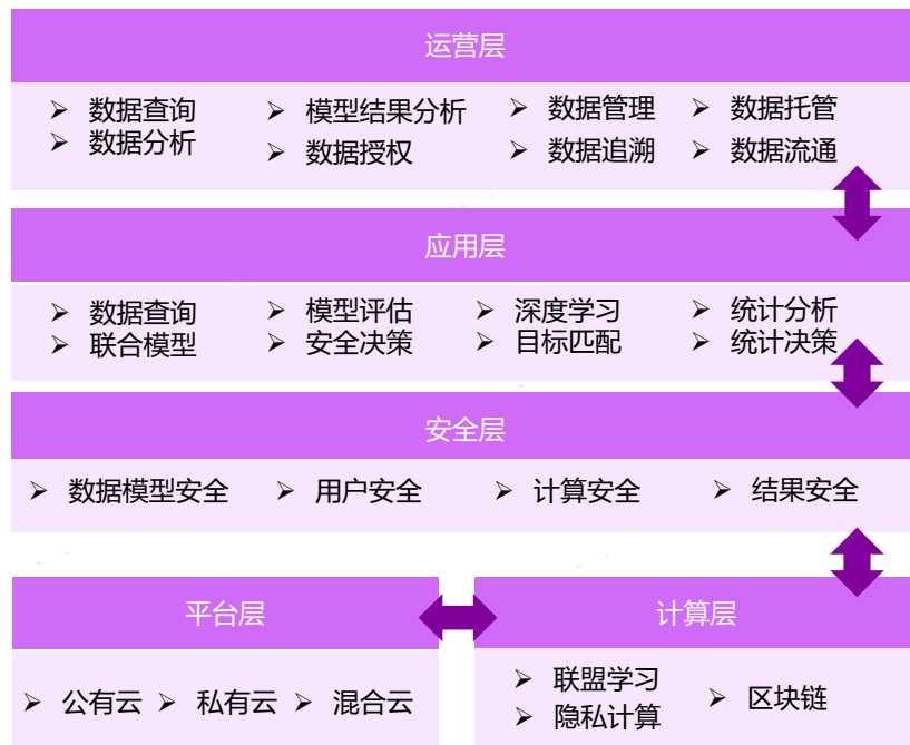
图：隐私计算平台技术架构体系
